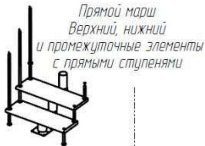
Схема расположения ступеней относительно опорных площадок металлического каркаса
